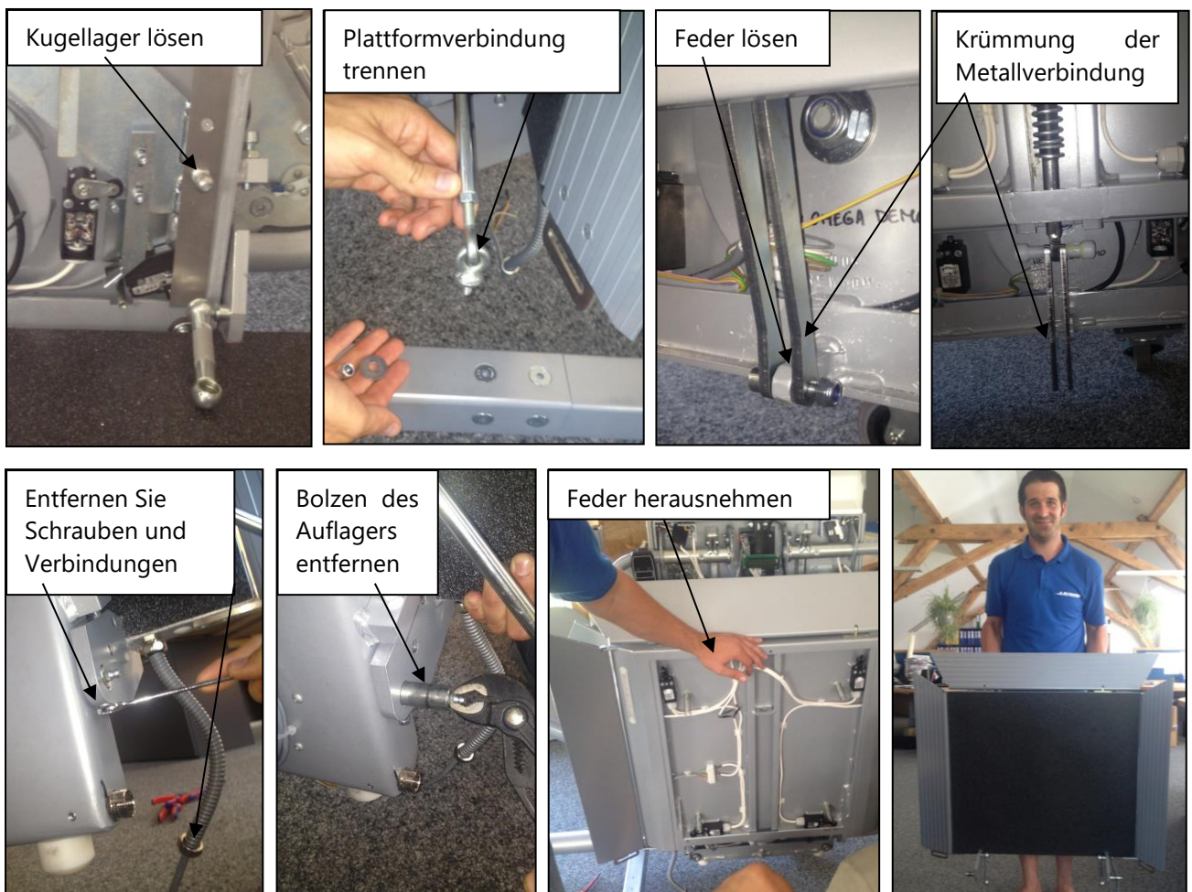
Abb. 27.1 - Anleitung Plattformboden abmontieren
