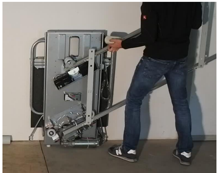
Abb. 9.2 - Einfahren der Schiene in die Fahrwerke von unten
