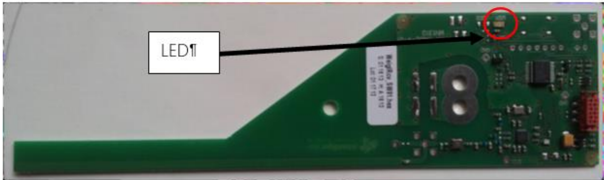
Abb. 26.1 - LED auf der Empfängerplatine
