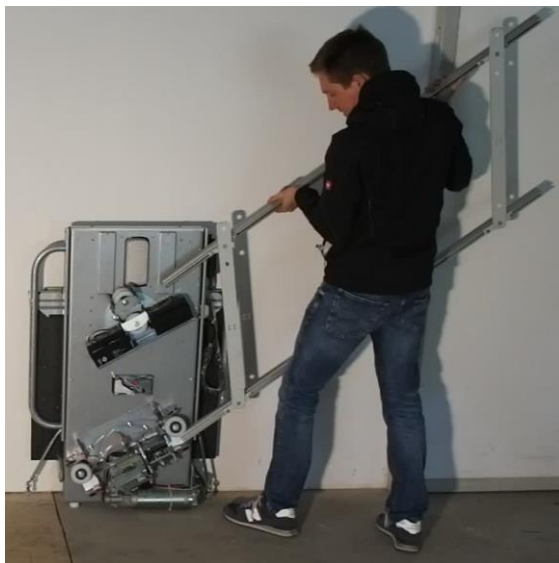
Abb. 9.2 - Einfahren der Schiene in die Fahrwerke von unten
