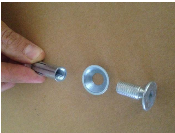
Fig. 8.4 - Para muros de hormigón
