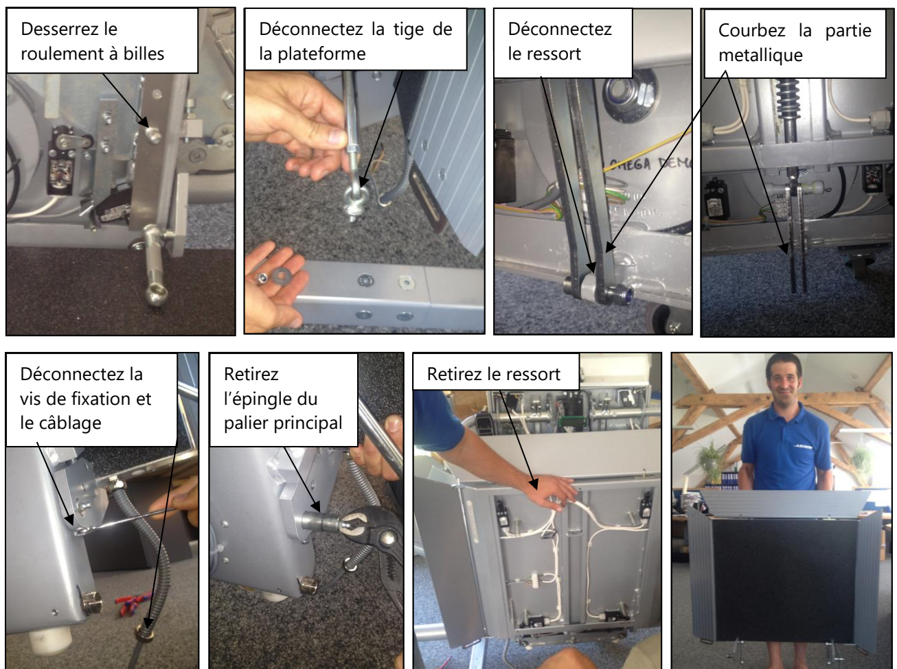
Fig. 27.1 – Démontez le plancher de la plateforme
