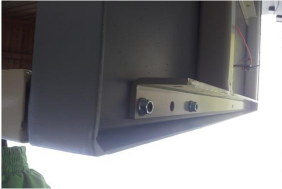
Abb. 3.12 - Muttern an der Plattformunterseite befestigen
