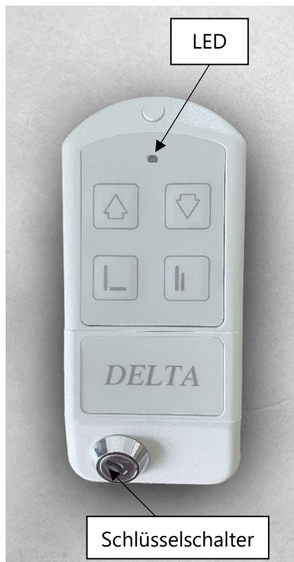
Abb. 5.5 – Erklärung Funkfernbedienung
