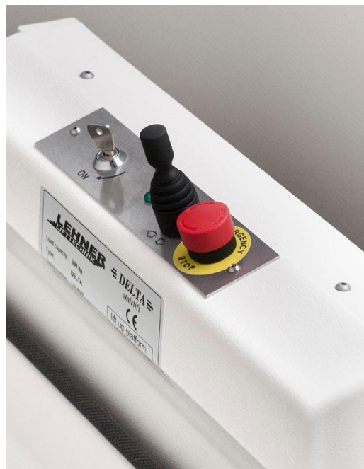
Abb. 5.3 - Bedienelemente auf der Plattform
