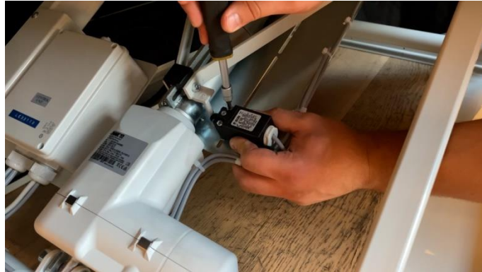
Fig. 5.8 - Ajuste de la altura de elevación
