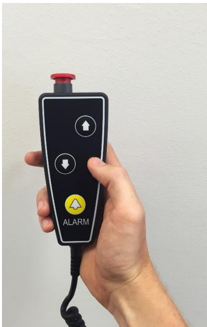
Abb. 5.3 - Handkassette am Spiralkabel
